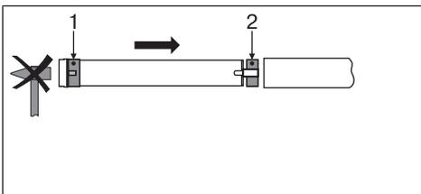
Montieren Sie den Rohrantrieb mit entsprechendem Ring (1) und Mitnehmer (2). Falls der Ring mehrere Nuten besitzt, wählen Sie die passgenaue Nut aus und schieben den Ring (1) auf den Laufring.
