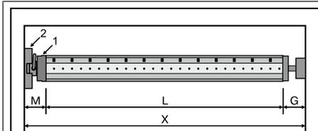
Ermitteln Sie den seitlichen Platzbedarf (M) durch Messen von Antriebskopf (1) und Wandlager (2). Das lichte Maß des Kastens (X) abzüglich des seitlichen Platzbedarfes (M) und Gegenlager (G) ergibt die Länge (L) der Wickelwelle:  $L=X-M-G$ .
